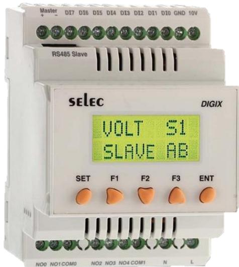
PLC compacto con HMI integrado
