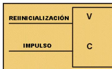
Por ejemplo, si estamos contando el número de artefactos que pasan delante del sensor físicamente conectado a la entrada 0001, entonces podemos poner contactos normalmente abiertos con la dirección 0001 delante de la línea de impulsos.
