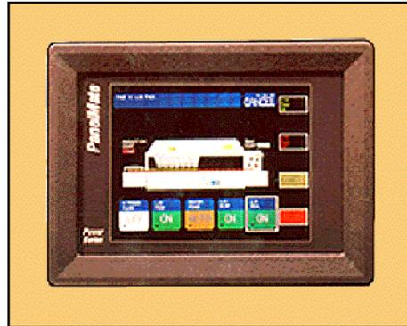
Los paneles de video control electrónicos pueden también reemplazar dispositivos de control estándares tales como botones pulsadores, lámparas e interruptores selectores, reduciendo así el número de dispositivos de entrada y salida que tienen que ser alambrados al PLC. Productos de paneles de video control están disponibles para conectarse al PLC a través de una amplia gama de opciones de comunicación, incluyendo conexión a:
