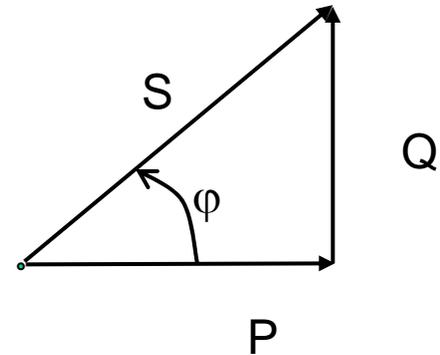
Se puede colocar una batería de condensadores de capacidad  $C$  en paralelo con la carga que genere parte de la  $Q$  consumida
