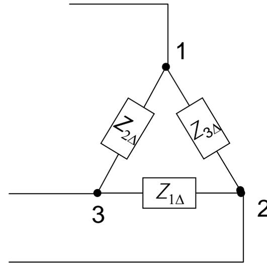
$$Z_{1\Delta} = \frac{Z_{1Y} Z_{2Y} + Z_{2Y} Z_{3Y} + Z_{3Y} Z_{1Y}}{Z_{1Y}}$$
